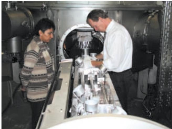
Carro en el que se coloca el aluminio de la Planta de Recubrimientos.
