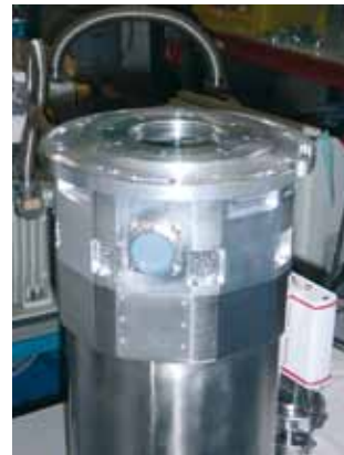
Arriba: Criostato durante las pruebas de verificación en Valencia.
