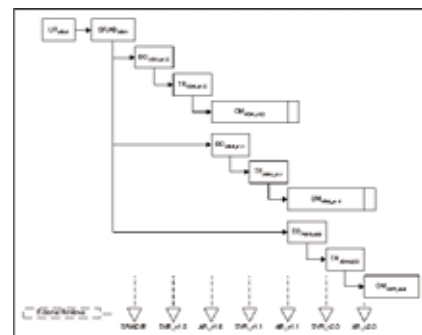
Figura 1: Ciclo de vida del software de a bordo de a aplicación. El modelo de desarrollo seguido es de entregas incrementales. (UR- User Requirements, SR-Software Requirement, AD-Architectural Design, DD-Detailed Design, TR-Software Transfer, OM-Operations and Maintenance).
