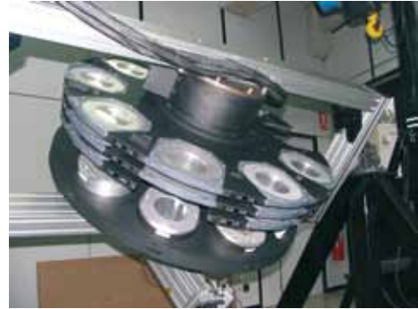
Sistema Selector de longitud de onda durante las pruebas de verificación en Barcelona.
