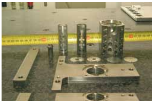
Componentes del instrumento GOLF-NG realizadas en el IAC y que corresponden a la envoltura y soporte de la celdilla de sodio del instrumento así como el alojamiento de las 47 fibras ópticas que miden la luz dispersada.
