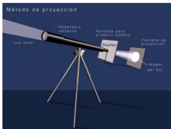
Figura 26. Método de proyección para la observación solar sin riesgo (créditos ESO, adaptado por J.C. Casado).
