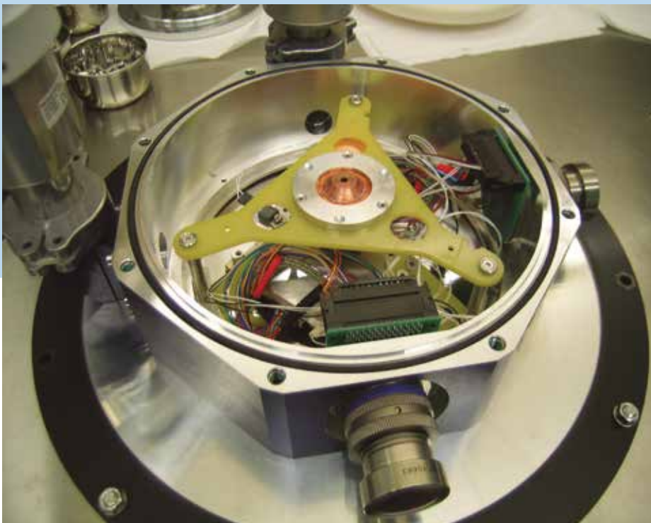
Figura: El Dewar abierto del WiFSIP y la nueva carcasa del detector antes de insertar el CCD.
