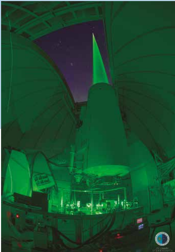
Figura 3: El haz de láser verde, visto desde el interior de la cúpula de la OGS, durante una «corrección de subida» con la que se pretende pre-compensar el láser en su trayectoria ascendente mediante un espejo deformable y mejorar así la densidad de la energía en el destino y atenúa el centelleo producido por la turbulencia atmosférica. Esta pre-compensación puede ser útil tanto en las comunicaciones ópticas con satélites como en la generación de estrellas de guía láser.
