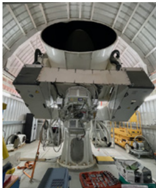
Instrumento TFGI instalado en el QT-2 TFGI instrument installed on QT-2
