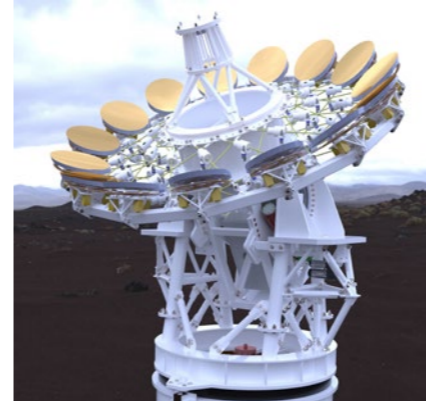
Diseño detallado del telescopio sELF.
