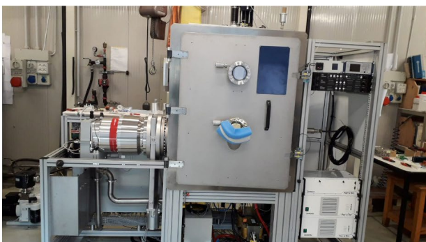
Sistema de cañón de electrones y el sistema de sputtering.
