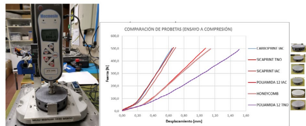
Banco de pruebas para el ensayo de compresión (izquierda) y gráfica representativa de algunos de los resultados del mismo (derecha).
