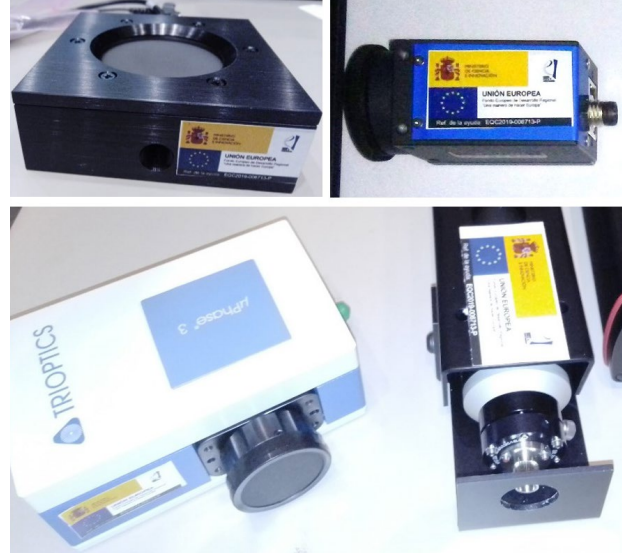
Bolómetro, sensor de frente de onda e interferómetro para diagnóstico láser.
