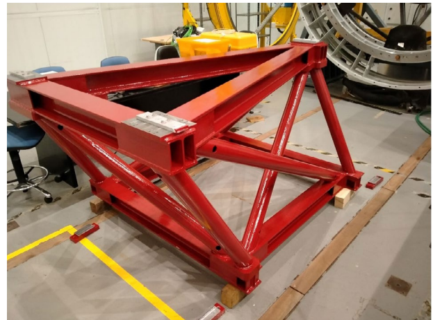
Estructura de soporte de GTCAO a la plataforma Nasmyth del telescopio GTC.
