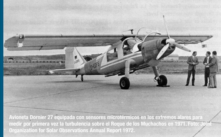
Avioneta Dornier 27 equipada con sensores microtérmicos en los extremos alares para medir por primera vez la turbulencia sobre el Roque de los Muchachos en 1971. Foto: Joint Organization for Solar Observations Annual Report 1972.
